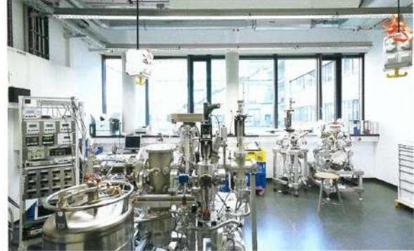
**Bild 11.** Typisches Labor des Instituts für Physik; für unterschiedliche Experimentieranordnungen müssen diverse Anschlüsse vorgehalten werden, auch eine flexible Medienversorgung von der Decke hängend (Fotos 1, 3–6, 9–11: HG ESCH)
