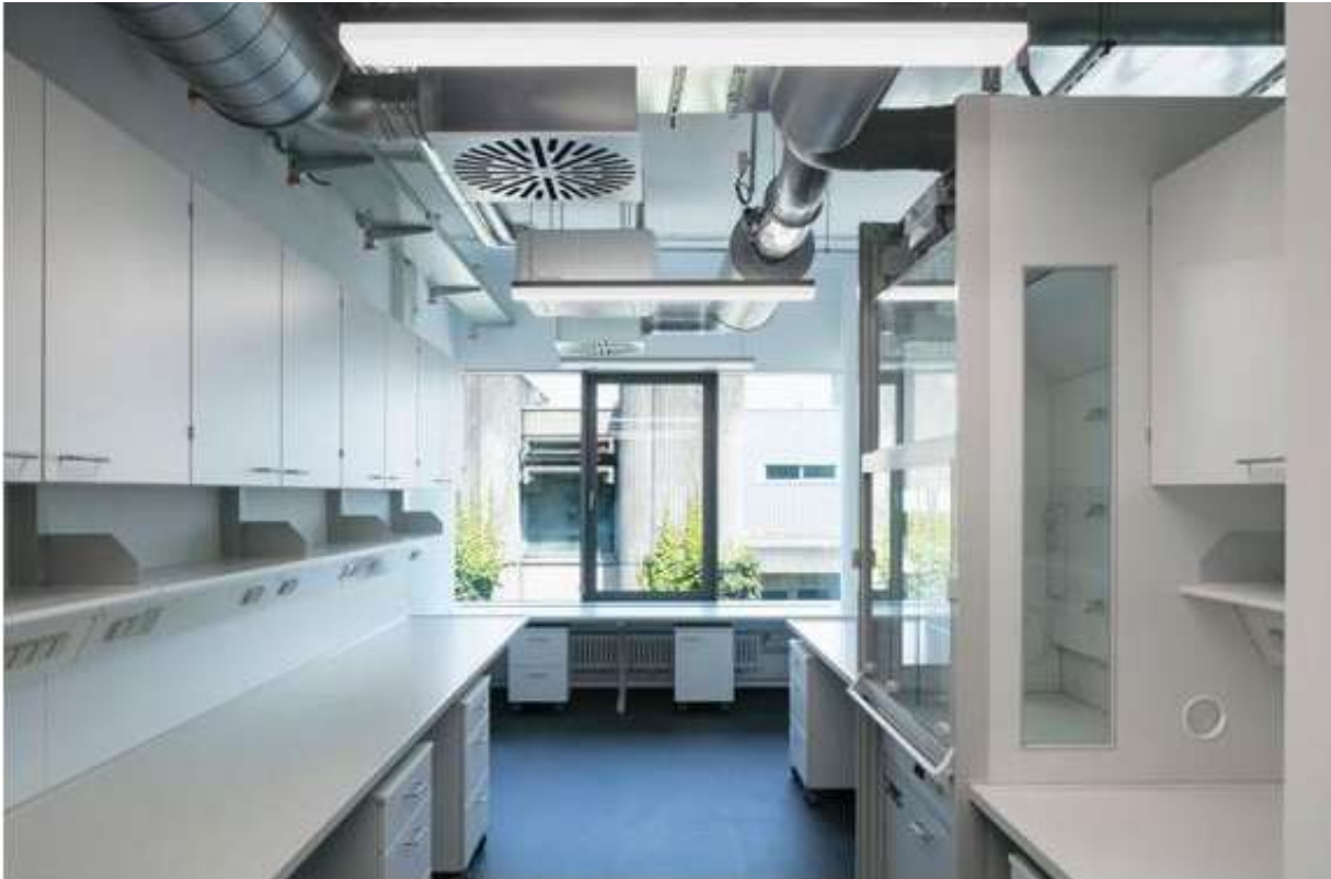
Ein variables Installationskonzept und ein modular aufgebautes Laboreinrichtungssystem ermöglichen eine flexible Grundrissgestaltung der Labore
