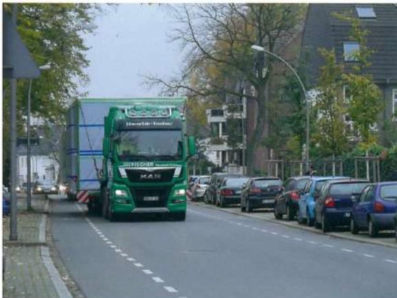
**Bild 2.** Ein Modul pro LKW wird als Schwertransport bis zur Baustelle gefahren
